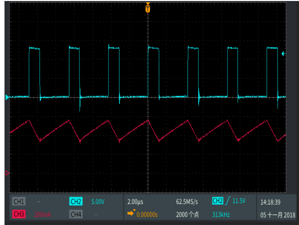
SW 脚与电感电流工作波形
